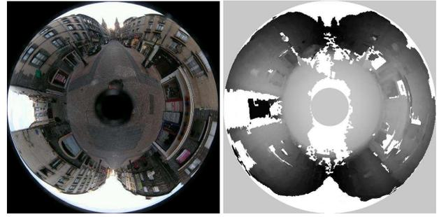
FIG. 4 – L’image de référence 211 et sa carte de profondeur (un pixel blanc est sans profondeur).
