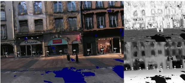
FIG. 7 – Trois vues de la “vieille ville” avec placage de texture (incluant les poses de la caméra), obtenue par sélection des modèles 3D locaux et la condition de fiabilité. Les orientations des morceaux/patches (ou cartes de profondeur) sont aussi donnés en niveaux de gris.
