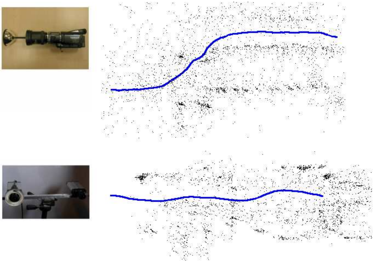
FIG. 5 – Trajectoires et vues de dessus des reconstructions 3D (trajectoires en bleu et points 3D en noir). En haut : caméra catadioptrique (séquence 2). En bas : paire stéréo (séquence 3).
