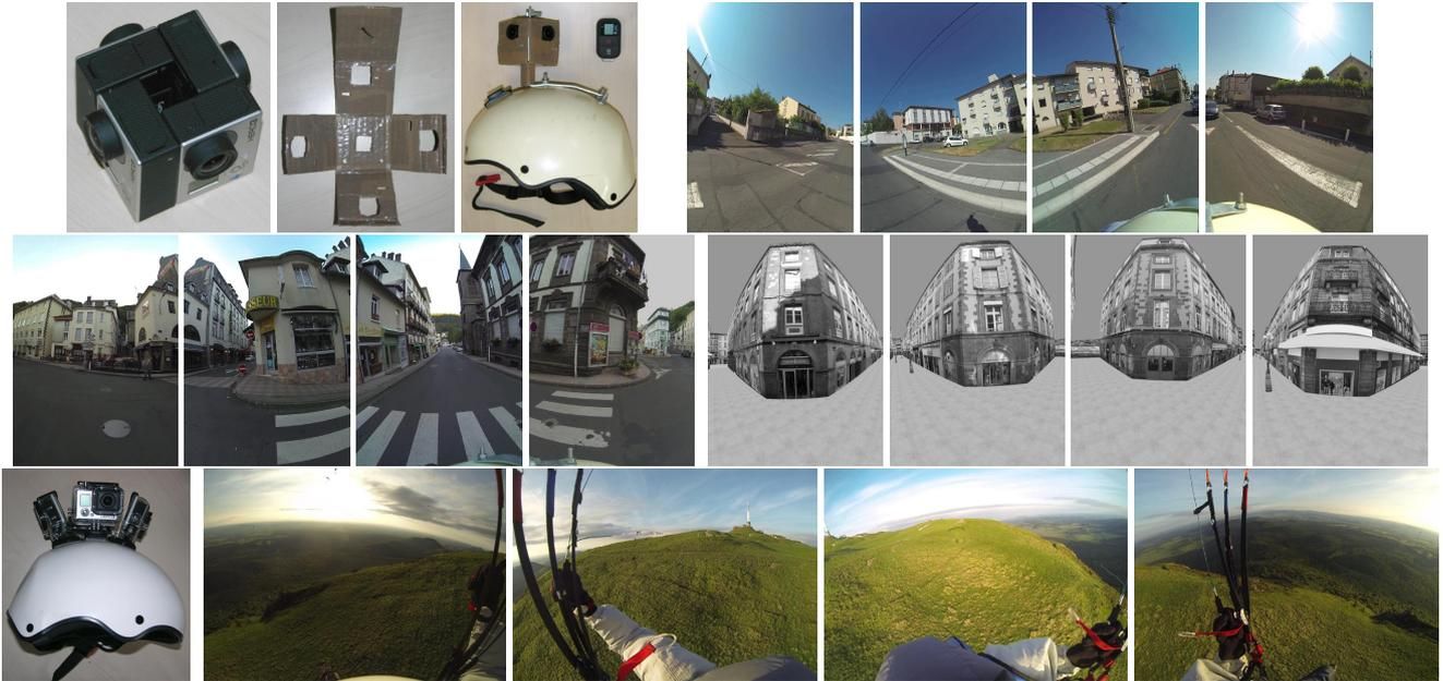
FIGURE 1 – Deux multi-caméras définies avec quatre Gopro Hero 3 et des images prises en un point pour chaque jeu de données. En haut et au milieu : les caméras sont dans une boîte en carton (pour avoir une distance faible entre les centres). En bas : les coques fournies avec les caméras sont utilisées.
