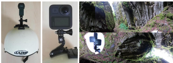
Figure 1: Une GoPro Max 360 et une image de cubemap.
