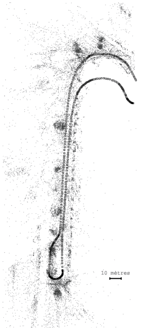
Figure 16. Reconstruction 3D d'une séquence de 400 m de long en aller-retour.
